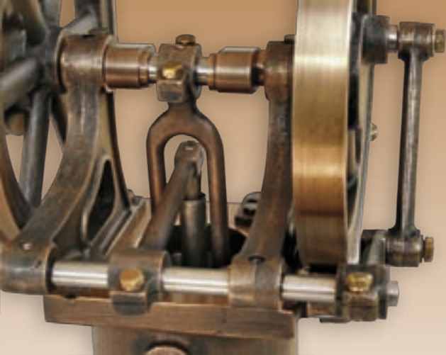
▲ Bild 13: Blick auf die Hebelmechanik zur Verdrängersteuerung
