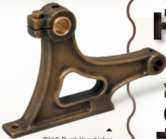
Bild 2: Durch Verschieben der Gleitlagerbuchse lässt sich das Axialspiel der Pleuellstange einstellen
