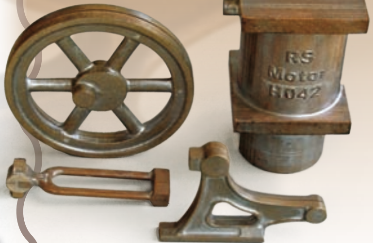
Bild 3: Einige der insgesamt 18 Holzmodelle, die anzufertigen waren
