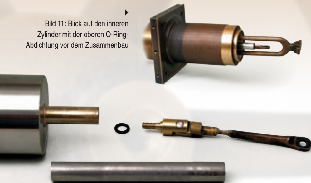
▲ Bild 8: Der Verdrängerkolben, das Pleuellager mit Pleuel und die Führungshülse vor dem Zusammenbau
