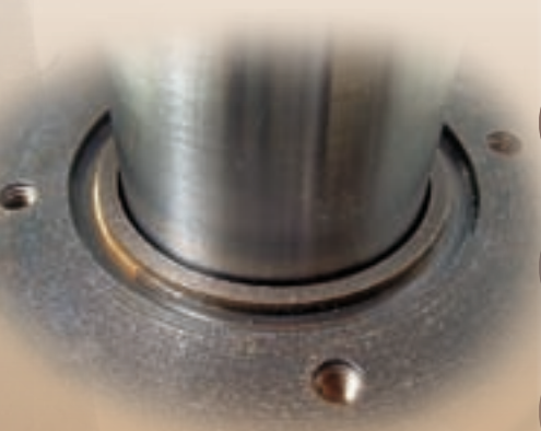
Bild 5: Der Verdrängerkolben bewegt sich mit nur 0,5 mm Spiel im Zylinder
