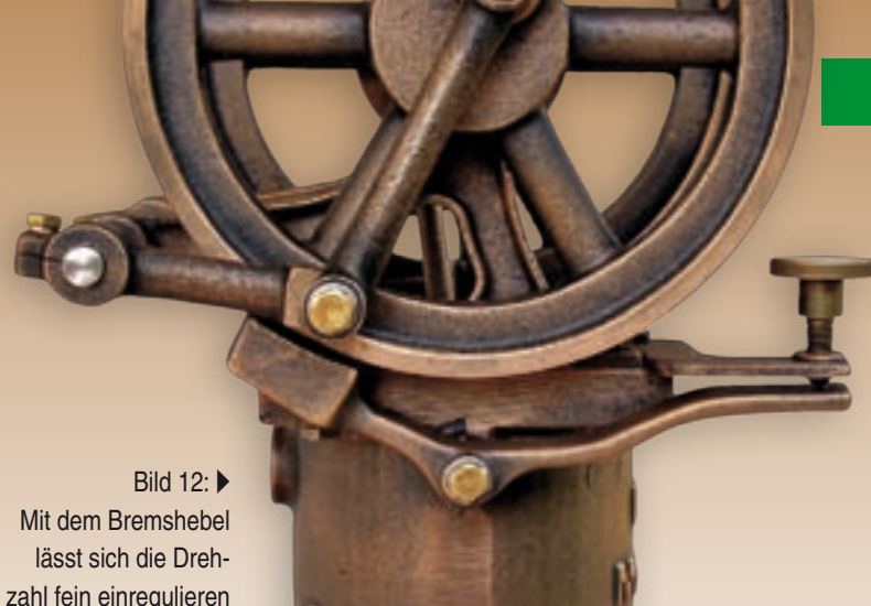
▲ Bild 13: Blick auf die Hebelmechanik zur Verdrängersteuerung
